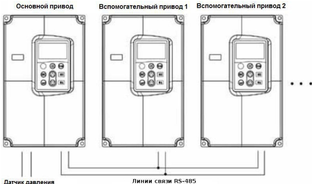
Принципиальная схема подключения преобразователей частоты в многоприводной насосной станции
