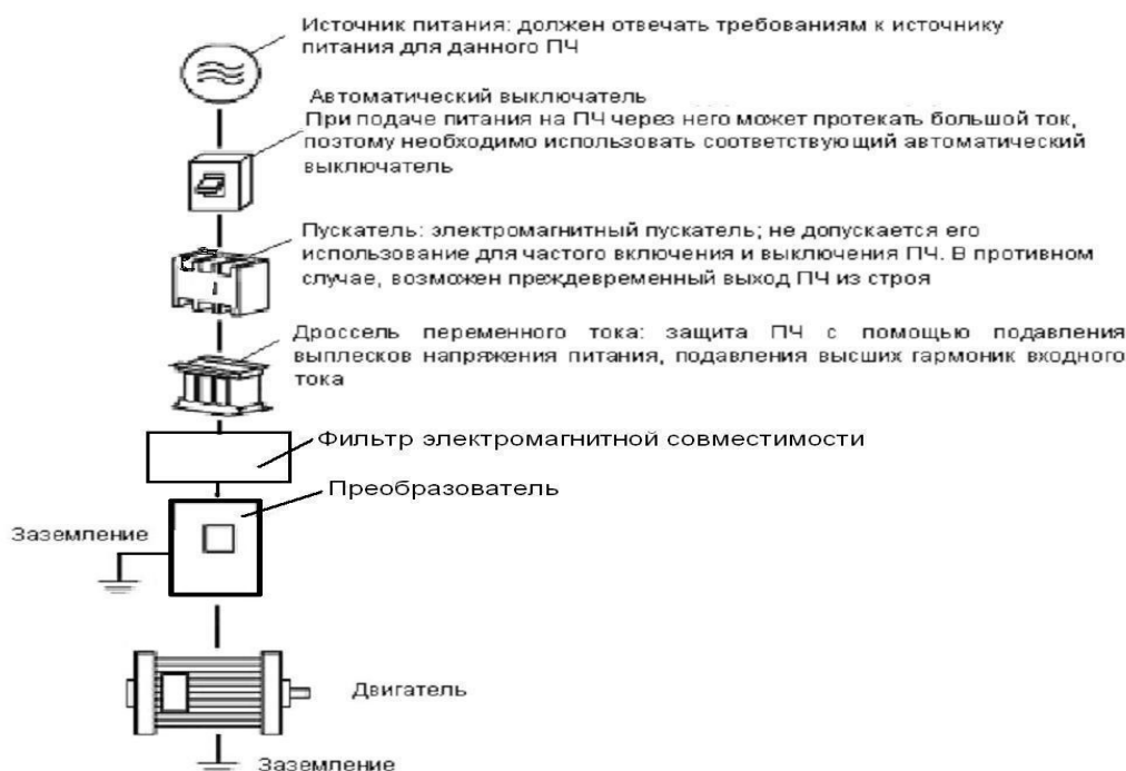
Схема электромонтажа основного силового контура
