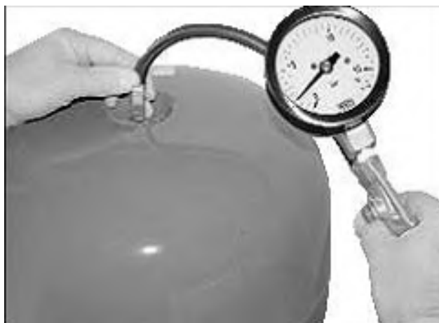
Рис. 9 Контроль давления в мембранном баке
