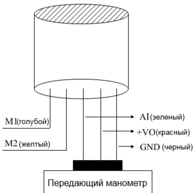
Схема подключения передающего манометра
