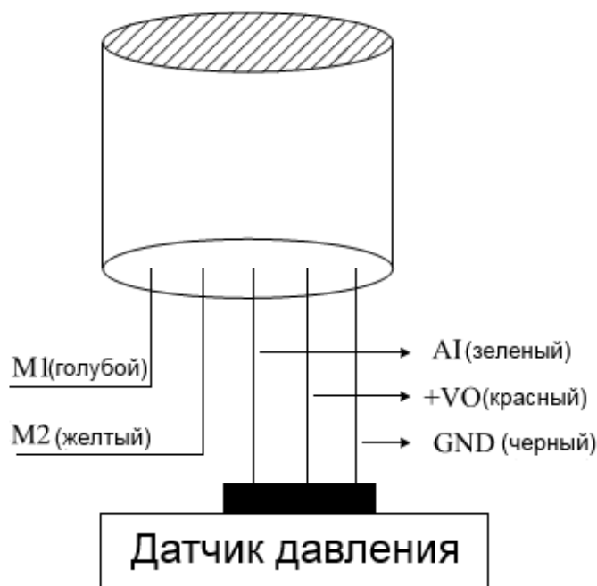
Схема подключения трехпроводного датчика давления
