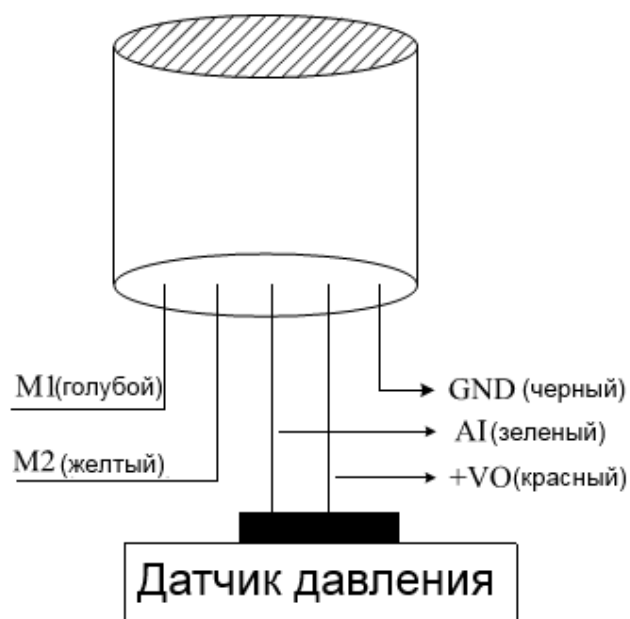
Схема подключения двухпроводного датчика давления
