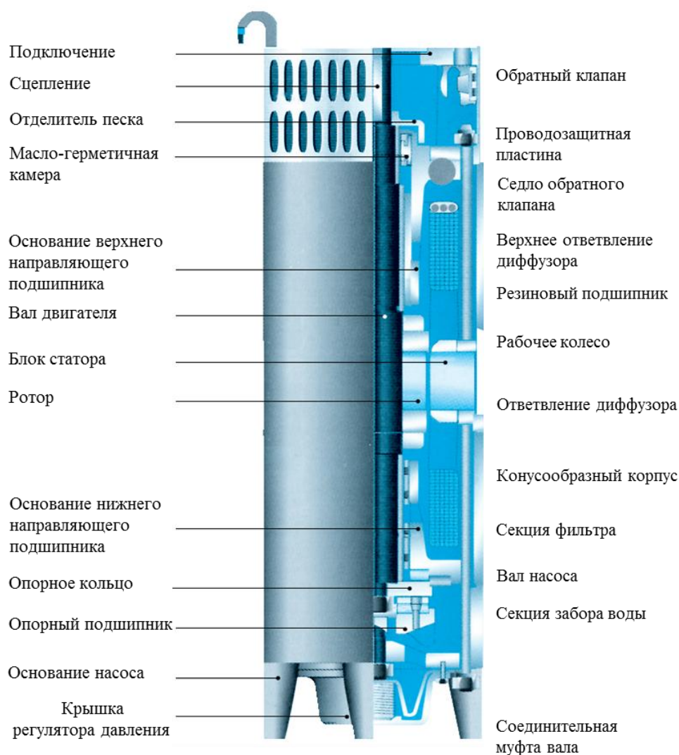
Рисунок 12. Структура двигателя погружного агрегата насосного SM
